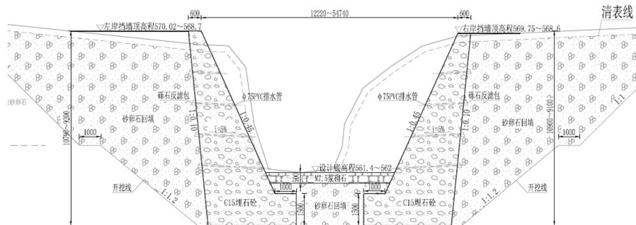
图 2-8 喇叭口排洪口典型横断面设计
