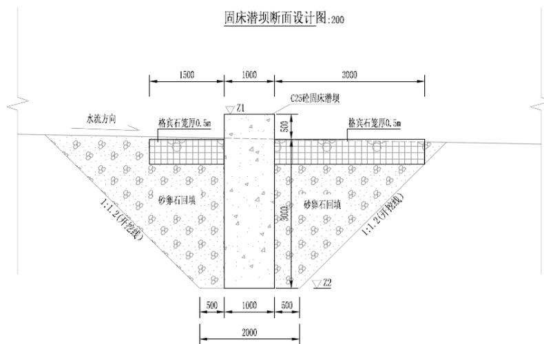
图 2-6 固床潜坝典型设计图 2
