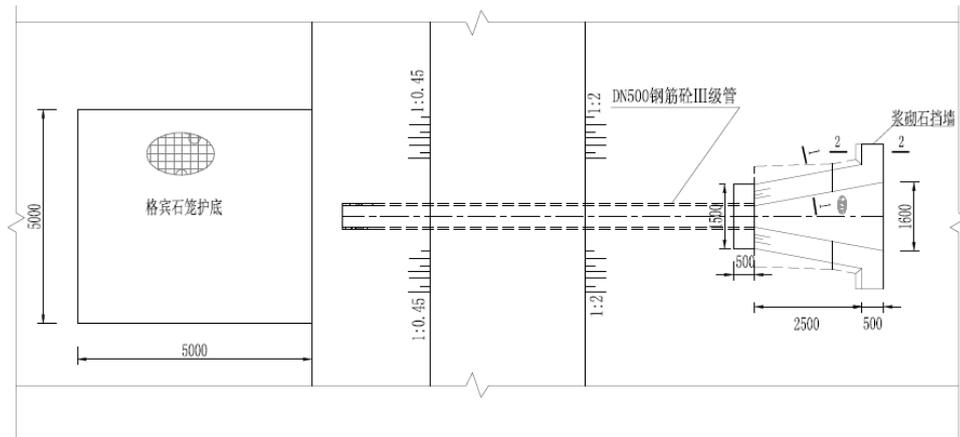
图 2-7 DN500 排水管涵平面图
