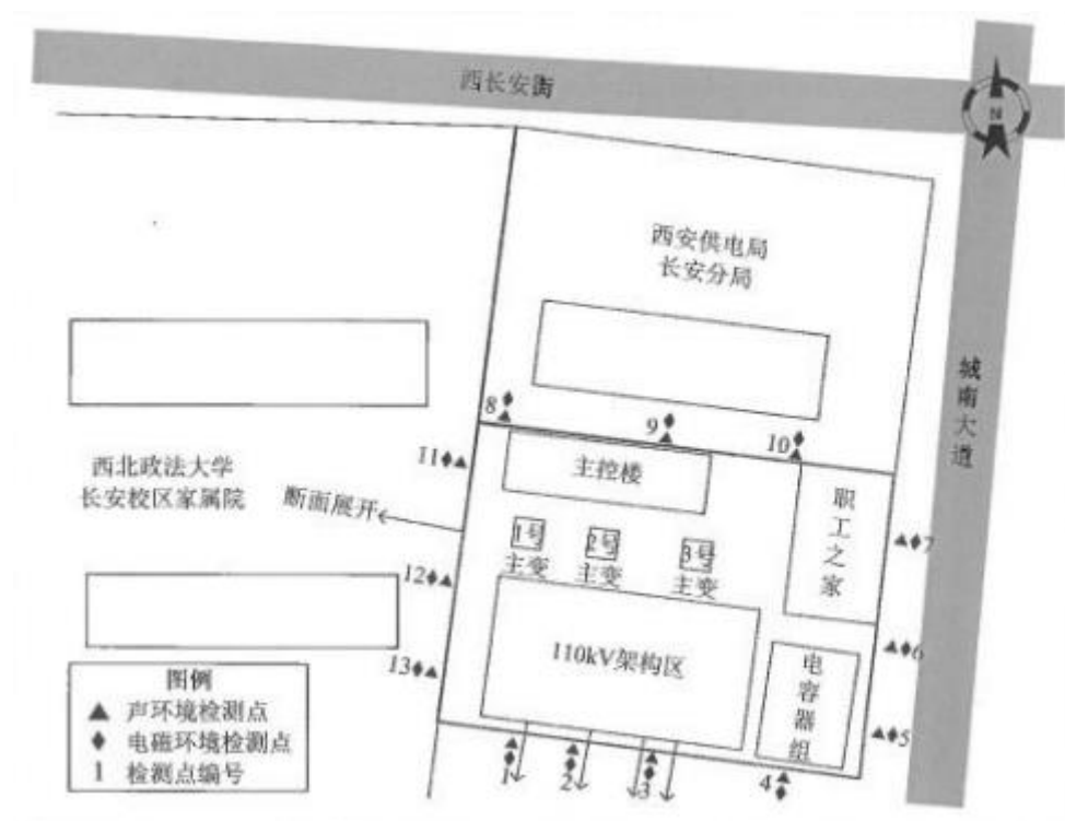
图 6.1-1 长安西 110kV 变电站监测点位图
