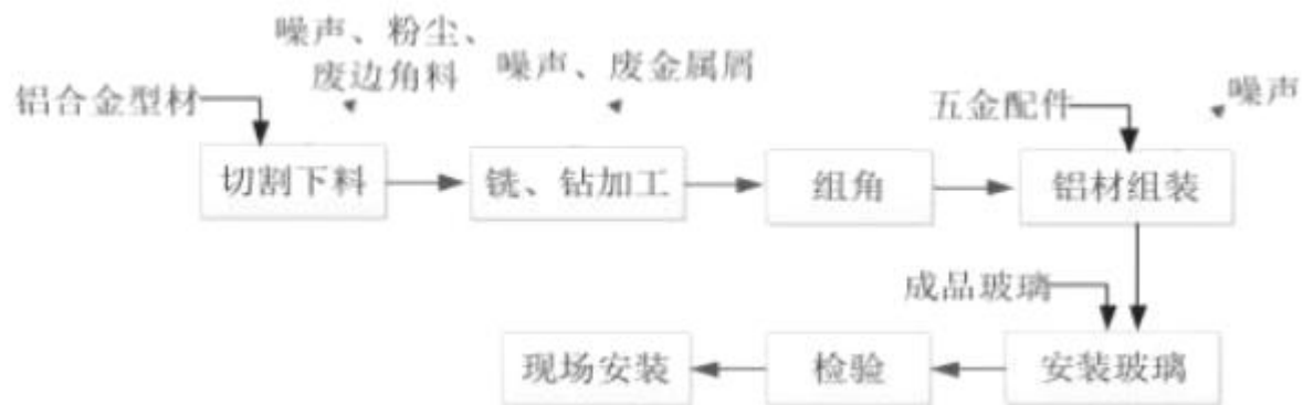
图 2-9 铝合金玻璃门生产工艺流程及产污环节图
