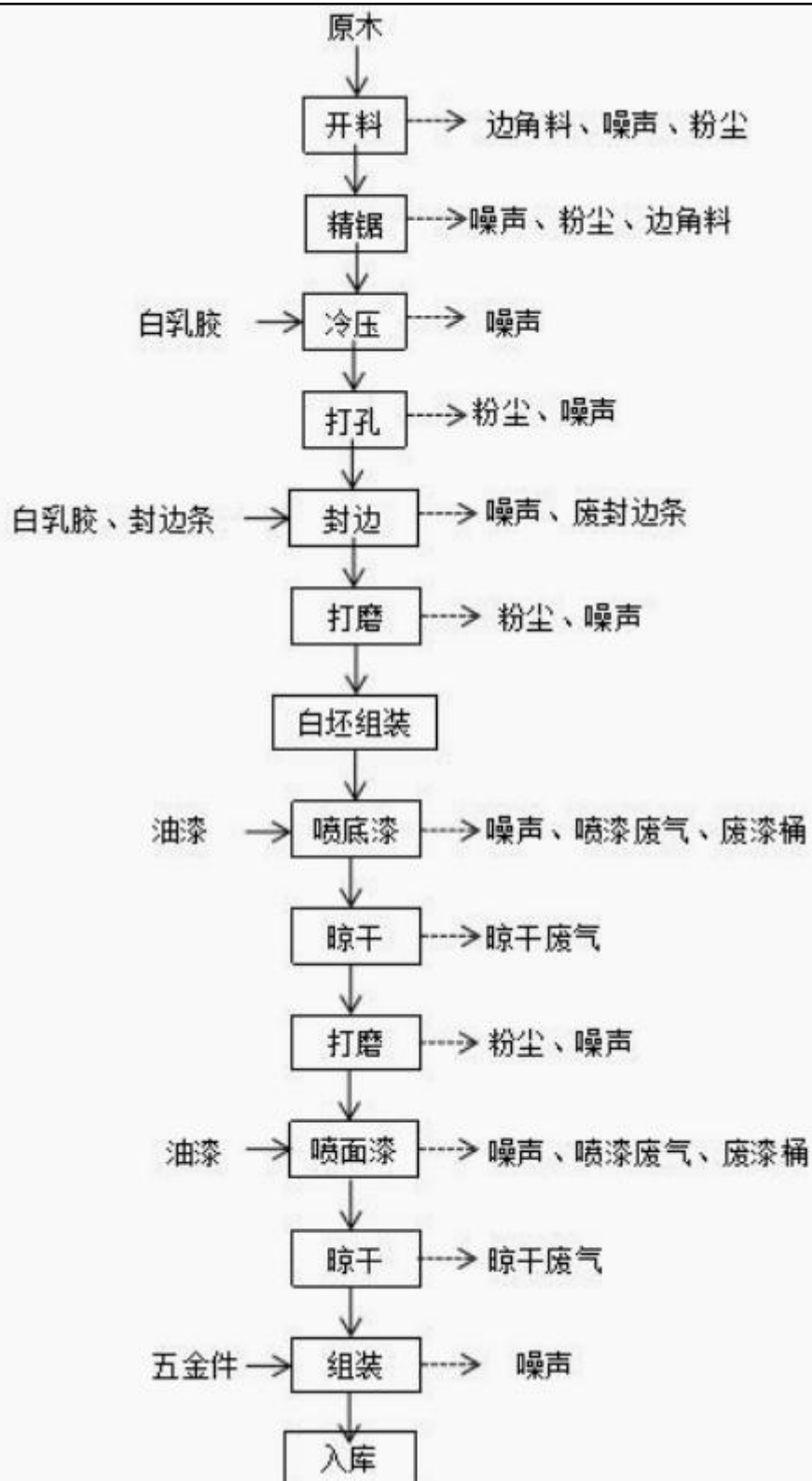
图 2-8 实木家具生产工艺及产污流程图
