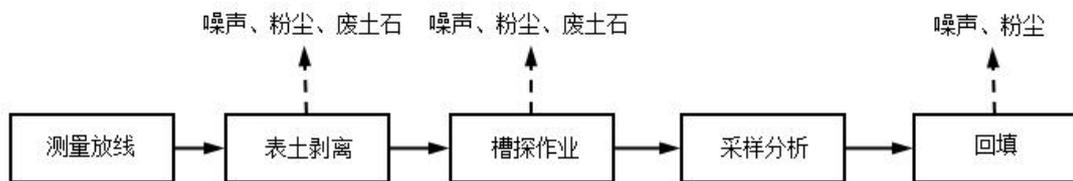
图 2-2 项目槽探工艺流程及产污环节图
