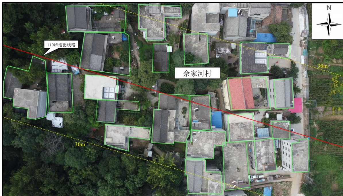
图3-6 本项目送出线路穿越舍家河村的穿越情况
