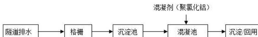
图 2-13 隧道工程施工工艺流程及产污环节图
