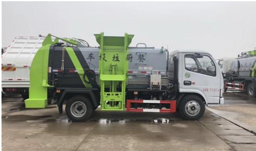
图 2.5-2 餐厨垃圾收运车
