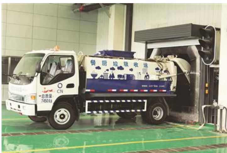
图 3.1-2 餐厨垃圾卸料工作图
