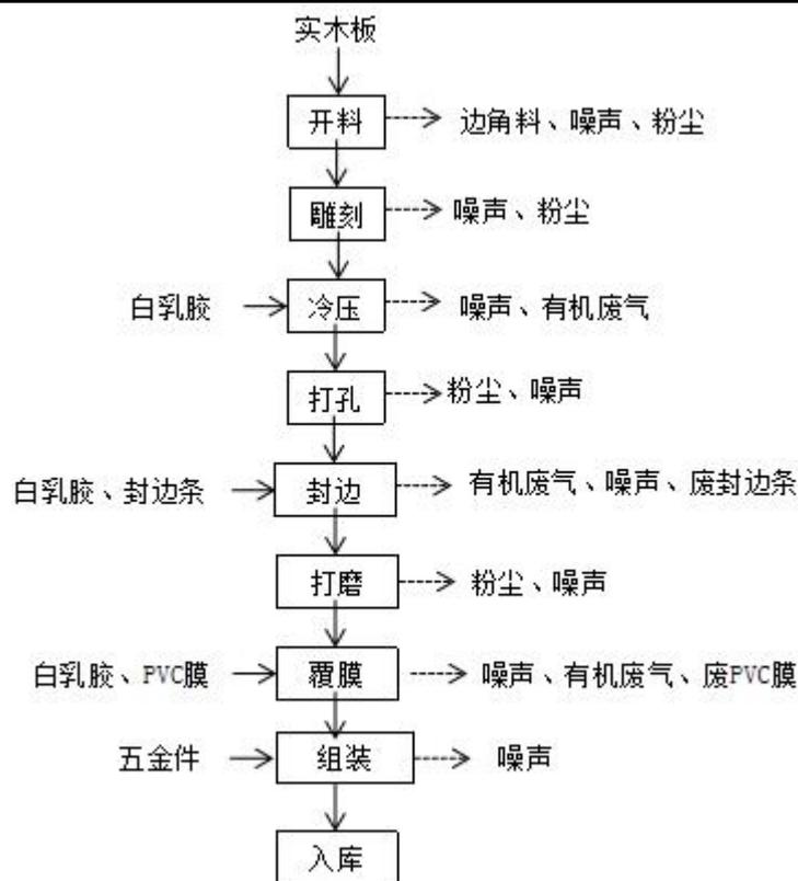
图 5-3 全屋定制家具生产工艺及产污流程图
